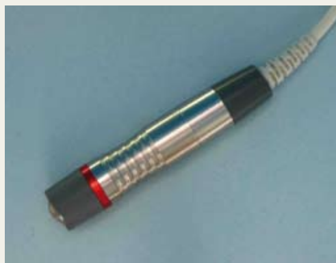
Komplett montierter SIDSP-Sensor. Alle notwendigen Messsignale werden vor Ort digital komplett aufbereitet und verarbeitet.
