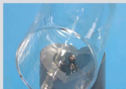
Les billes de référence spécialement traitées assurent une reproductibilité maximale des mesures.
