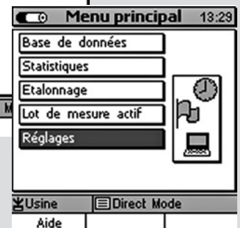
Interface d'utilisateur guidé par menu MiniTest 7400 FH
