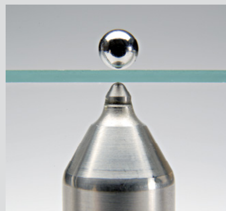
Les billes de référence spécialement traitées assurent une reproductibilité maximale des mesures.
